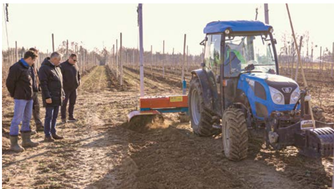
Założenie sadu demonstracyjnego z wykorzystaniem innowacyjnej metody w postaci frezarko-sadzarki
